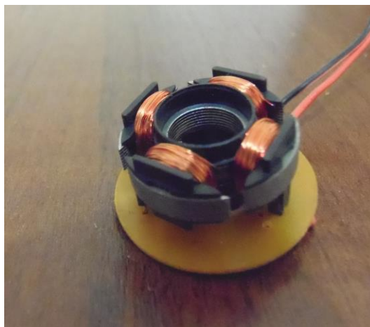
Figura 1: Eletroímã usado na ventoinha de computador
